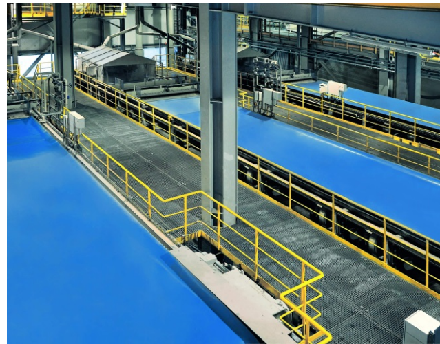
Bild 2: Eine Schlüsselrolle in der Phosphorgips-Entwässerung haben die VACUBELT®-Filterbänder, die GKD individuell auf die in jedem Prozess anderen Phosphorgips-Eigenschaften auslegt und thermisch einstellt.
