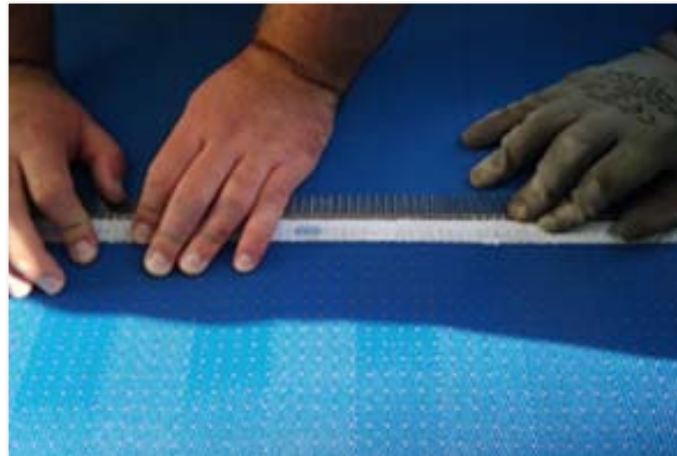
Bild 6: Die Enden des umlaufenden Prozessbandes werden durch die patentierte GKD PAD-Naht miteinander verbunden.
