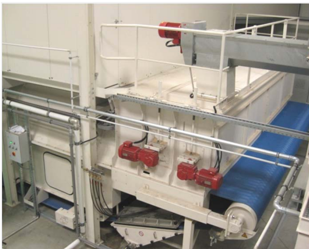
Bild 7: GKD-Gewebebander vom Typ CONDUCTO® 5065 sind trotz geringer Maschenöffnung hoch luftdurchlässig.
