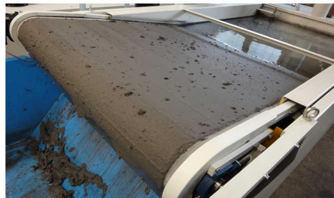
Bild 4: MAXFLOW-Bandfilter mit selbstreinigendem Endlos-Edelstahlgewebeband von GKD.
