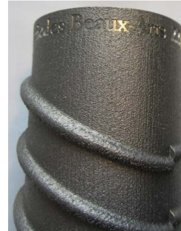
Bild 13: GKD entwickelte zusammen mit der FH Aachen die Lösung zur Hightech-Fertigung des Schwertes für Dominique Perrault mittels Selektiven Laserschmelzens.
