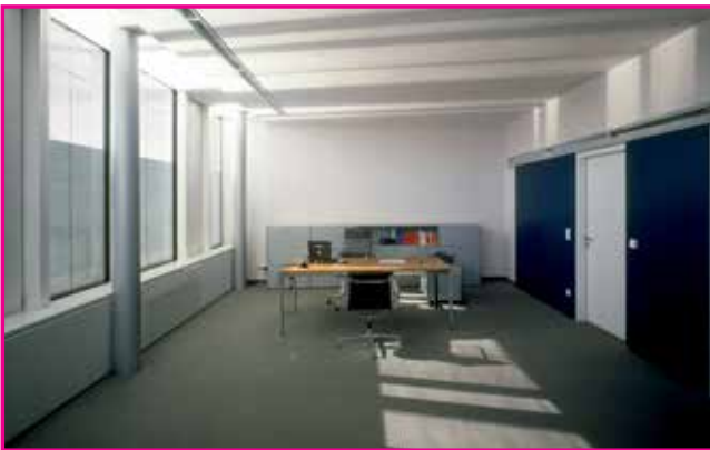
Verteilung des Lichts bei einer konventionellen Decke
