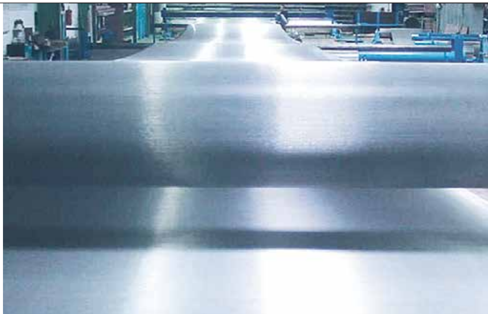
1. OSB-Platte mit Prägung 2. Skizze kontinuierliche Presse 3. Press-/Prägeband auf GKD-Streckbank
