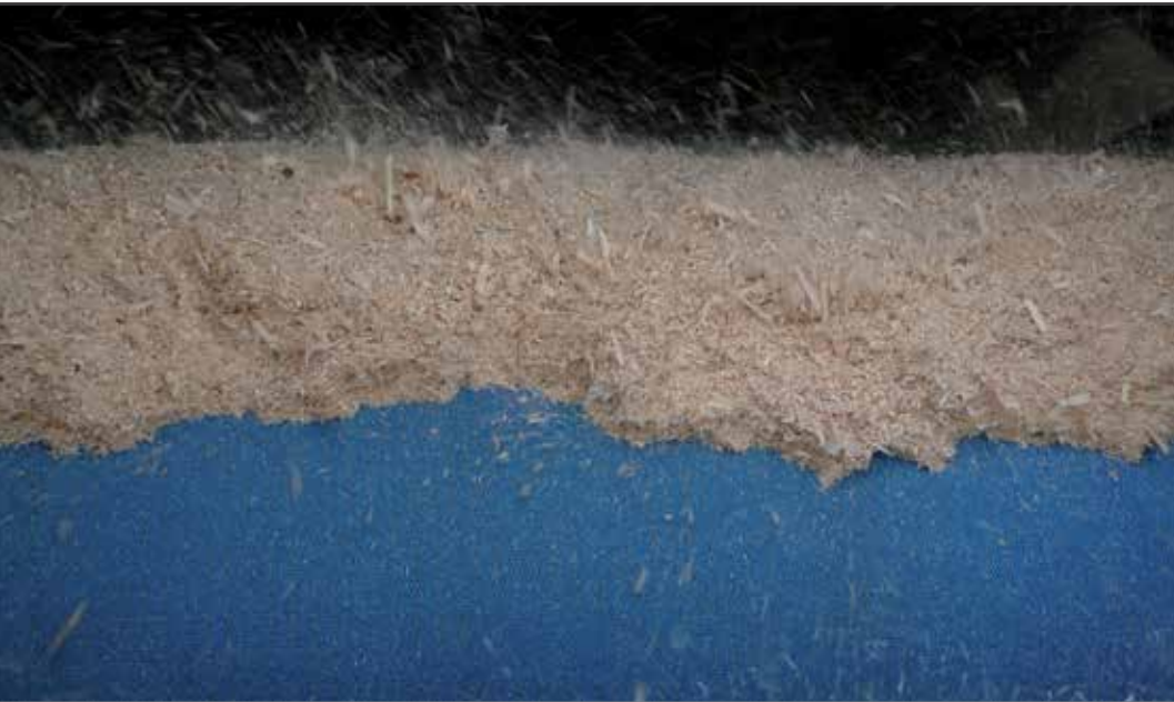
1. CONDUCTO-Prozessbänder für die Holzspanrocknung 2. PAD-Naht 3. CONDUCTO 5065
